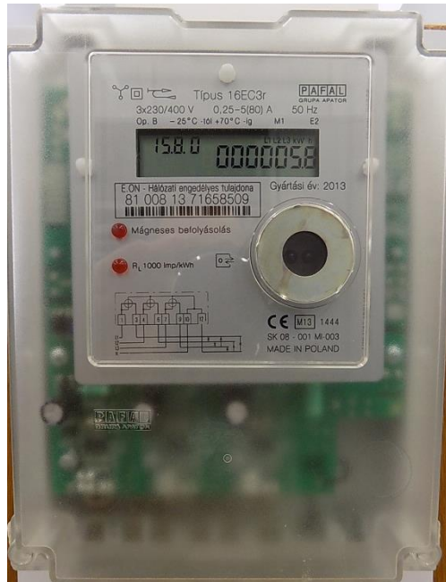
3 fázisú, típusa, 16EC3r 3x5-80 A; 6 egész 1 tizedes felbontás a nem átlátszó fedelű mérő feszültségmentes állapotban is olvasható
