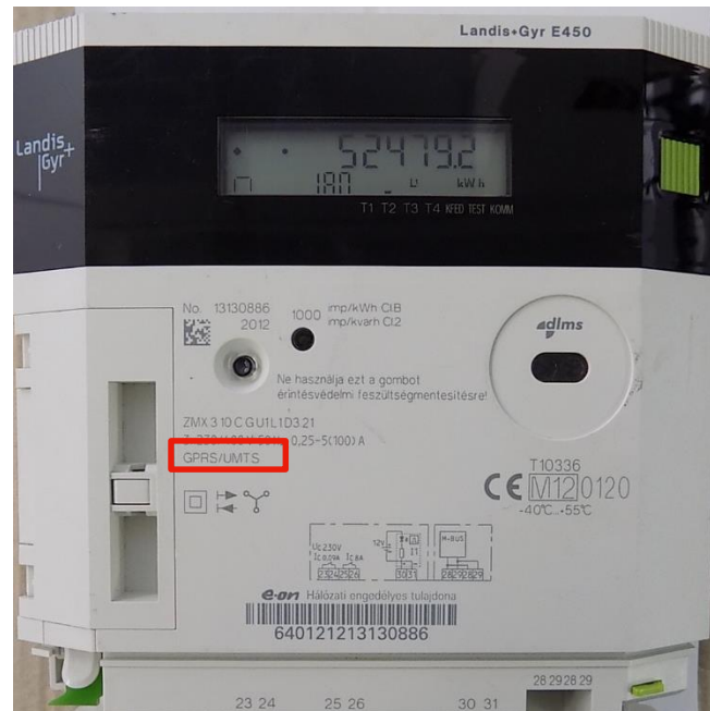
3 fázisú, típusa, E450 3x5-100 A 6 egész 1 tizedes felbontás Kommunikáció: GPRS.
