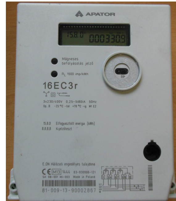
3 fázisú, típusa, 16EC3r 3x5-80 A; 6 egész 1 tizedes felbontás a nem átlátszó fedelű mérő feszültségmentes állapotban is olvasható
